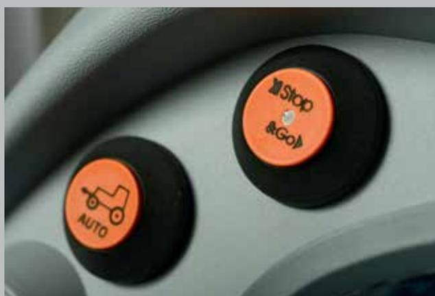
Stop&Go. Arranque y pare el vehículo cómodamente sin usar el pedal del embrague.
