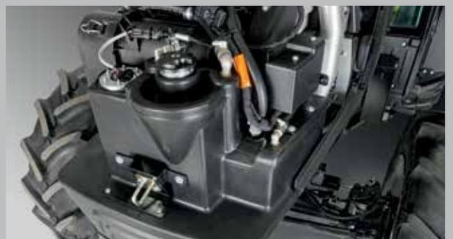
El depósito de combustible integrado en el bloque del eje delantero puede rellenarse con el capó cerrado, mientras que un depósito adicional está situado debajo del chasis.
