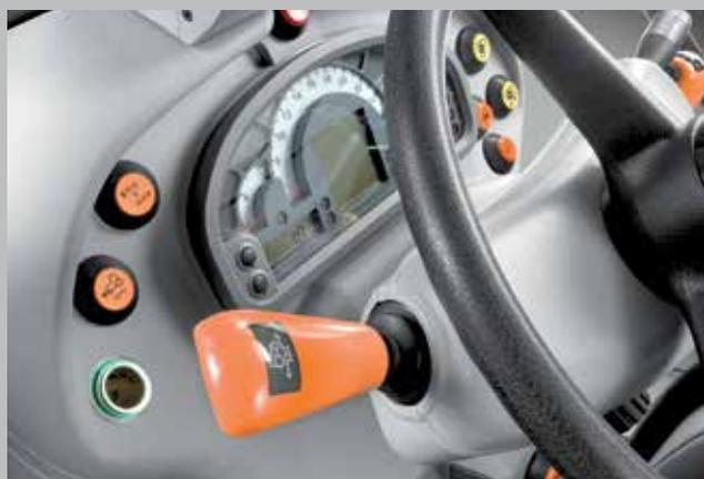
Inversor hidráulico. Cambie el sentido de la marcha con un simple toque.
