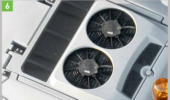
6 Sistema de aire acondicionado de alto rendimiento para lograr un ambiente de trabajo siempre agradable en la cabina.
