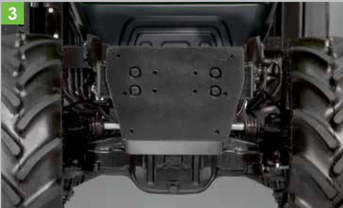
3 Placa de montaje delantera para permitir un enganche seguro y rápido de los aperos especiales.
